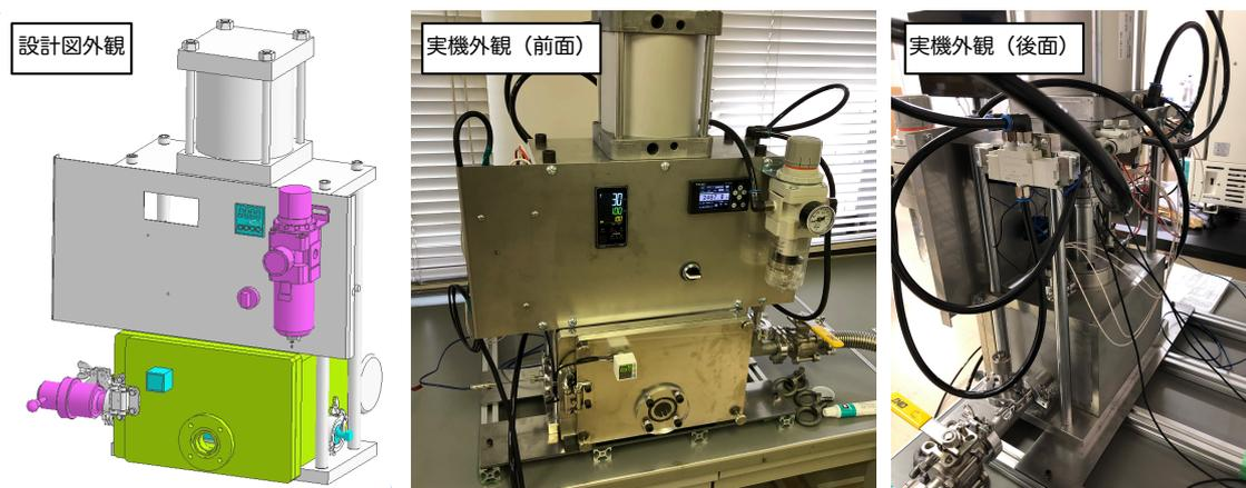
図2 設計・開発した固相拡散接合装置
